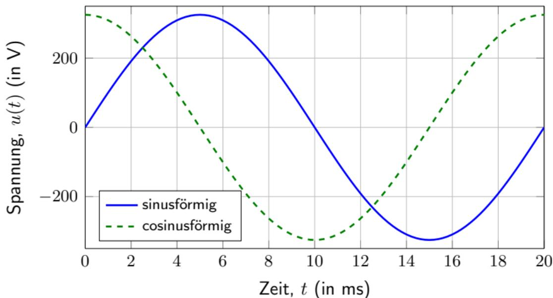
**Abbildung:** Harmonischer Zeitverlauf einer Spannung mit einer Frequenz von 50 Hz und einem Effektivwert von 230 V
